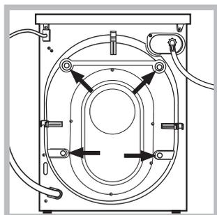
3. Снимите 4 винта, предохраняющие машину в процессе перевозки, и резиновую заглушку с соответствующей распорной шайбой, расположенные в задней части стиральной машины (см. схему).
